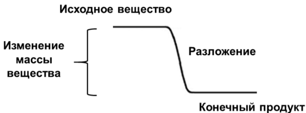
Рисунок 6. Пример термогравиметрической кривой [62]
