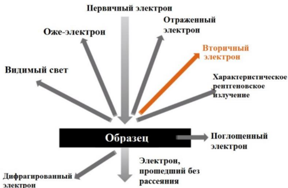
Рисунок 4. Рассеивание электронов в SEM [60]
